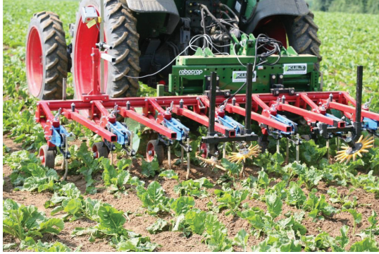
Şekil 7. Kameralı Otomatik Dümenleme Sistemine Sahip Çapa Makinası (Kunz vd., 2015).
