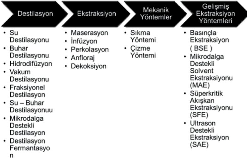
Şekil 1. Bitkilerden uçucu yağ elde edilmesinde kullanılan yöntemler (Yaman ve Kuleaşan, 2016).
