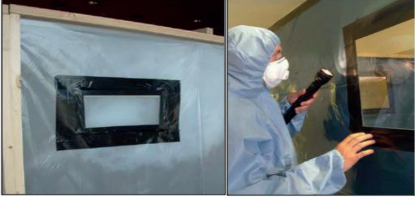
Şekil 4.11. Duman testi kontrolü (İş Sağlığı ve Güvenliği Genel Müdürlüğü, 2019).
