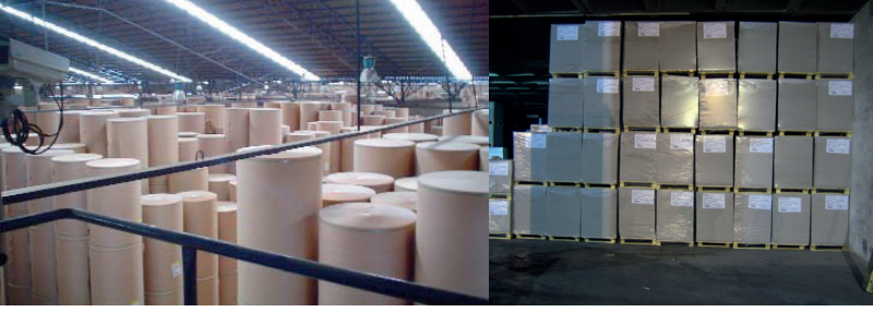
Şekil 2. Bobin kâğıtların dikey istiflenmesi (solda) ve tabaka kâğıt deposu (sağda) [Mapfre] [19].
