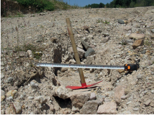
Fotoğraf 7. Çalışma sahasının merkezi kesiminde Büyükkıran T'den Baldıran Çayı'na katılan kesimde gelişme gösteren oyuntu erozyonu
