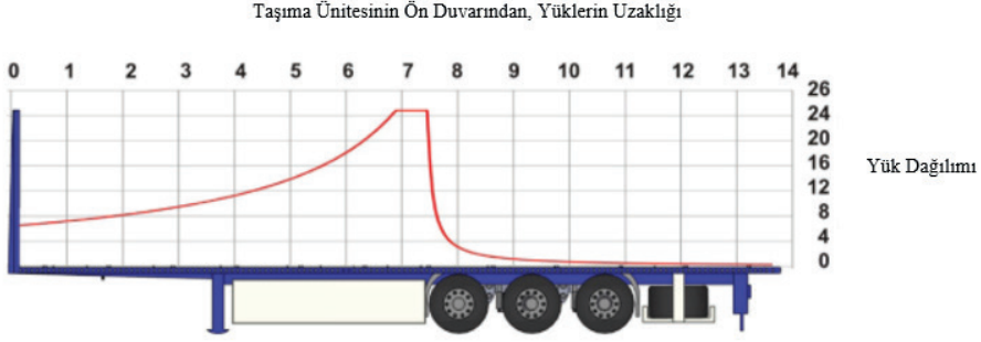
Şekil 2 Üç Dingilli Bir Yarı-Römork İçerisindeki Yük Dağılım Diyagramı
