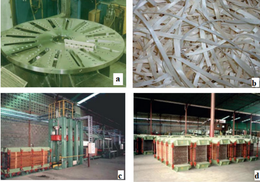
Şekil 13. Eltomatic CVS-16 yongalama diski (a), şerit yongalar (b), presleme (c) ve kürleme (d) (Van Elten, 2006b).
