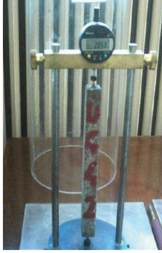
Şekil 10. ASTM C227 Standardına göre boy ölçüm düzeneği
