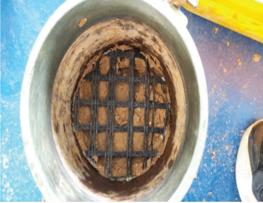
Şekil 4. CBR kalıbına yerleştirilen geogrid
