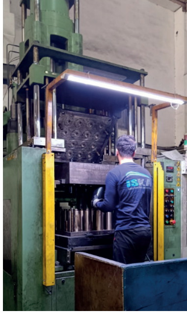
Şekil 9. Kauçuk Enjeksiyon Presinde AEM Conta Üretimi
