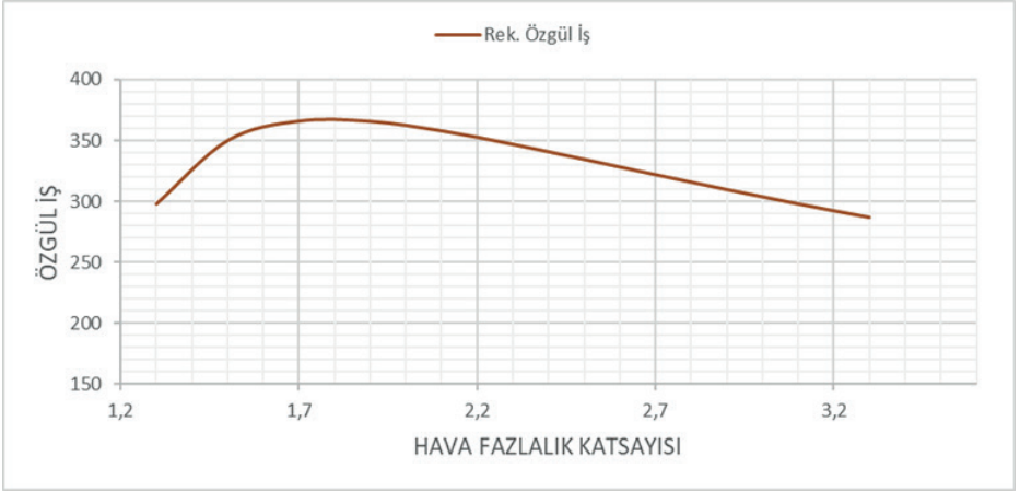
Şekil 8. Reküperatörlü kojenerasyon tesisinde özgül işin hfk-hava fazlalık katsayısı ile değişimi.
