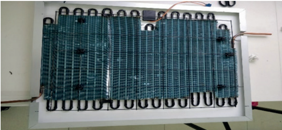
Şekil 2. Arkasına radyatör yerleştirilmiş PV panel
