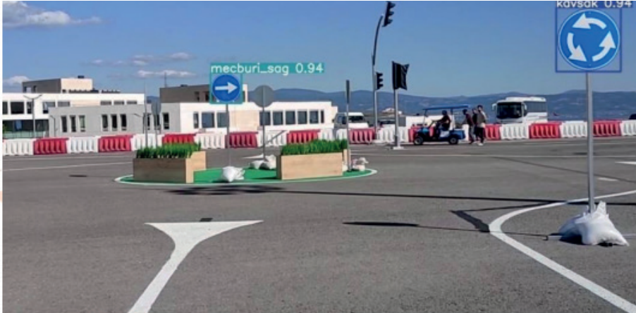
Şekil 14. Yolov5 ile Test Edilmiş Trafik Levha Tespiti
