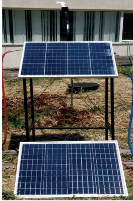
Şekil 5. PV Radyatörlü panel ve radyatörsüz (yalın) panel
