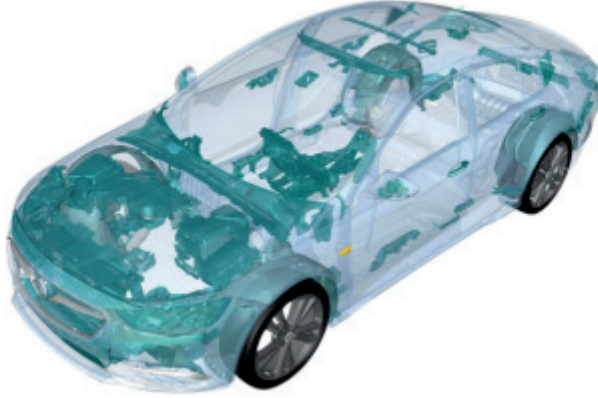
Şekil 2. Opel Insignia aracındaki geri dönüştürülmüş plastik parçalar (Anon n.d.-c)
