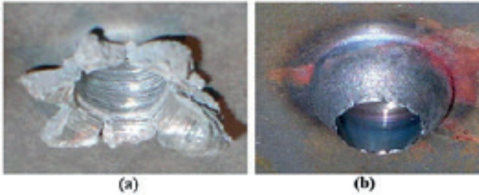
Şekil 10. SDY'de oluşan kovan biçimleri: a) Gevrek (Al380) malzeme, b) Sünek (AISI 1020) malzeme [25].
