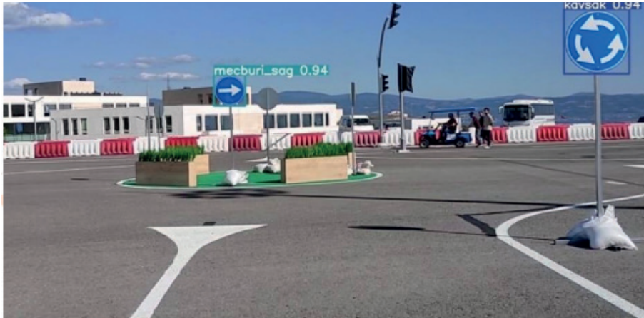
Şekil 14. Yolov5 ile Test Edilmiş Trafik Levha Tespiti
