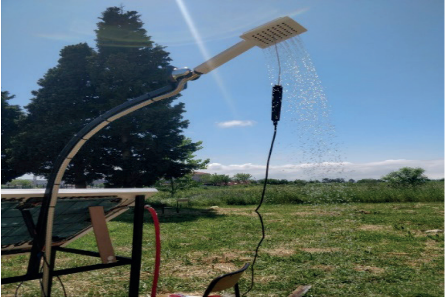
Şekil 6. Su akış ve çıkış sıcaklığı ölçümü
