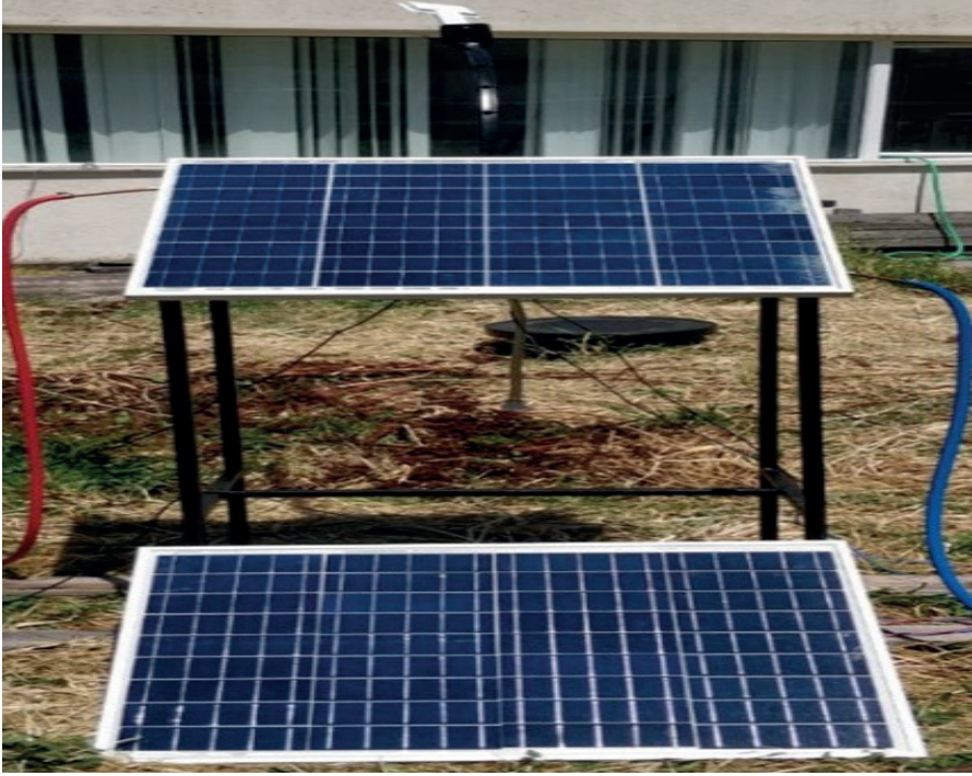
Şekil 5. PV Radyatörlü panel ve radyatörsüz (yalın) panel
