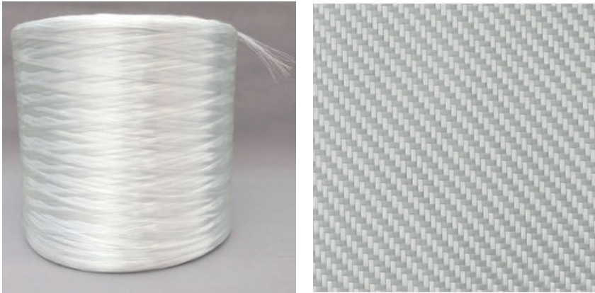
Şekil 2: Cam liflerinin iplik ve kumaş halleri
