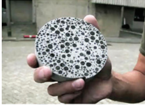
Şekil 1. Kendi kendini onaran beton [2]
