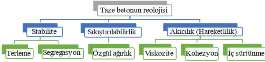
Şekil 2. Taze betonun reolojisini tanımlayan parametreler
