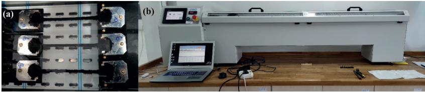
Şekil 4. Düktilite deneyinin yürütülüşü: (a) deney cihazı içerisinde sabit hızdaki çekme kuvvetine maruz bırakılan numuneler ve (b) deney cihazından yük-ve deformasyon verisinin bilgisayar aracılığıyla kaydedilmesi.
