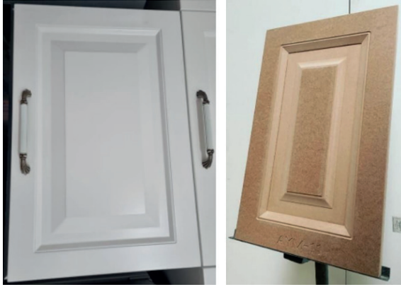
Œekil 10: Ham MDF Kapak Üstüne Uygulanan Freze ve Bunun Beyaz Lakeli Hali (Özbay, S.,2022).
