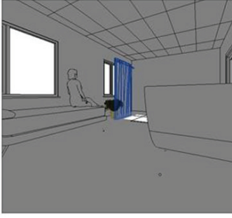
Görsel 8: Gün ışığının öğlen 12:23'teki geliş yönü (Revit programı üzerinden çizilmiştir, Kişisel Arşiv)
