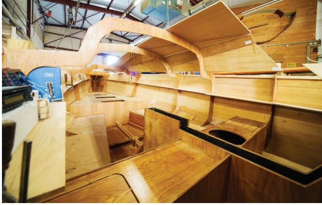
Görsel 8: Kontrplak Malzemenin Yat Sektöründe Kullanım Örneği (URL8)
