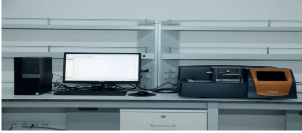
Şekil 22. TA Instruments / SDT 650 TGA Analiz cihazı
