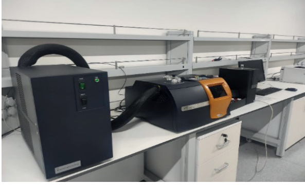
Şekil 18. TA Instruments / DSC250 Diferansiyel Taramalı Kalorimetri (DSC)
