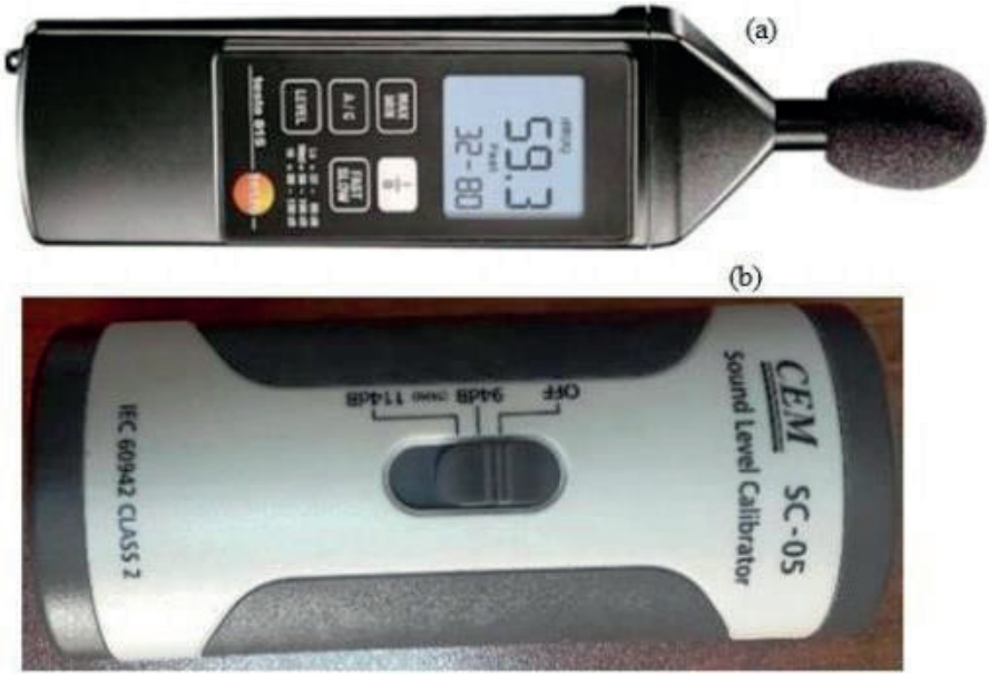
Şekil 1. (a)Testo 815 ses seviyesi ölçer ve (b) CEM SC-05 ses seviyesi kalibratörünün fotoğrafı
