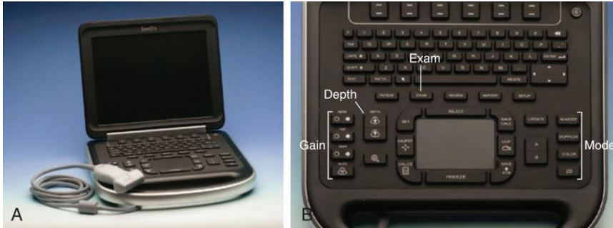
Şekil 4: A- taşınabilir bir ultrason cihazı. B- makinenin klavyesi ve kontrol tuşları. (Soni ve ark., 2019)
