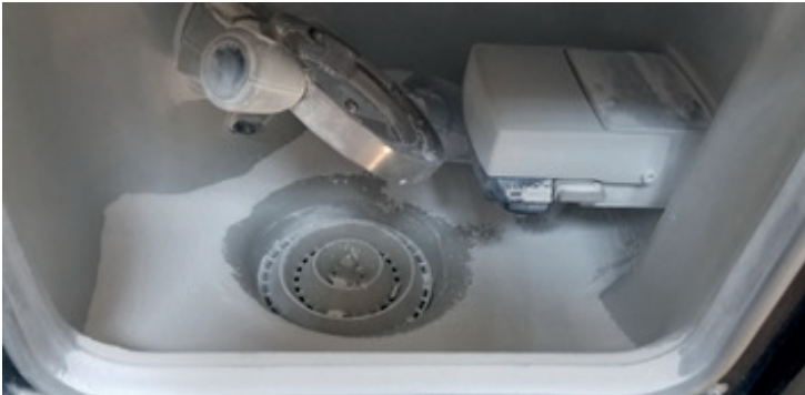
Şekil 2. Kazımalı üretimde oluşan artık materyal
