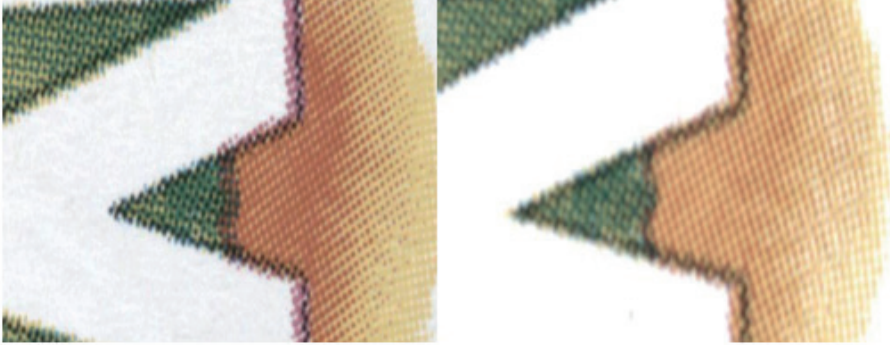
Şekil 17: Baskı tekrar boyunun başı ve sonu: Soldaki kırmızı rengin daha çok olduğu, sağdaki kırmızı rengin daha az olduğu tram görüntüleri
