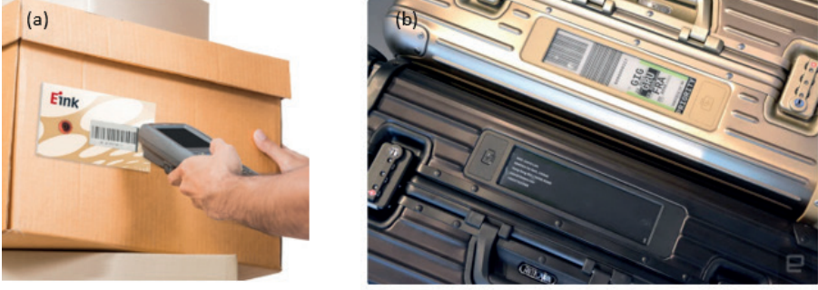
Şekil 13. (a)E-mürekkep teknolojili koli etiketi ve (b) bagaj etiketi görüntüleri (Lai, 2016; Logistic Box, 2023).
