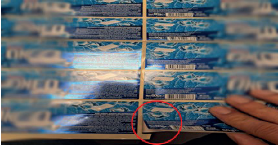
Şekil 3: Pergamini(taşıyıcısı) kesilmiş/patlamış baskılı bir etiket örneđi
