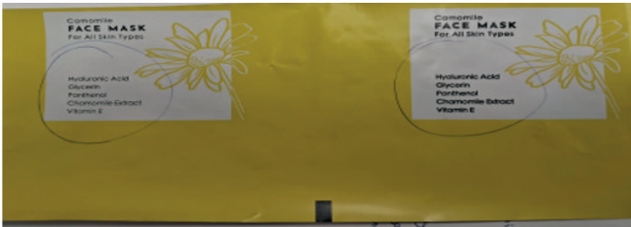
Şekil 16: Siyah kalıptaki salgı probleminin dolayısıyla yazılar arasındaki boyut değişikliği
