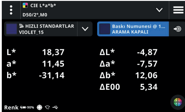
Şekil 9: Lab ve Delta E değerlerinin gösterildiği spektrofotometre ekranı
