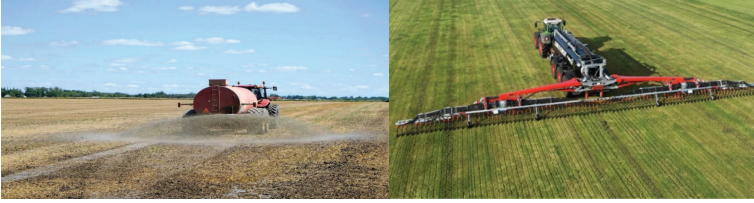
Şekil 12. Yüzeye Serpme Dağıtma Yöntemi ve Toprak Altına Enjekte Yöntemi
