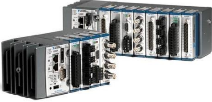
Şekil 3.22 NI CompactRIO platformu
