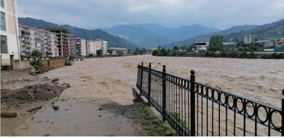
Şekil 4. Taşkın düzlüklerinin imara açılması neticesinde daraltılan ve yönü deđiştirilen dere yatađı rüsubat taşıma ve depolama potansiyelini önemli ölçüde kaybederek taşkına geçer (Arhavi, Artvin).
