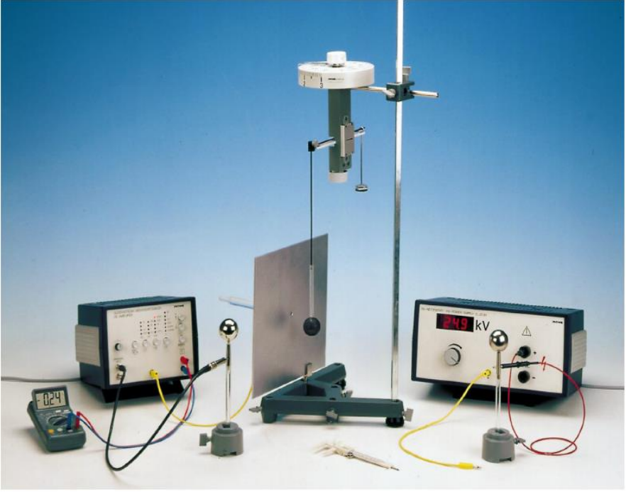
Şekil 2.2 Top üzerine etkiyen elektrostatik çekici kuvvetin ölçülmesi için deneysel düzenek
