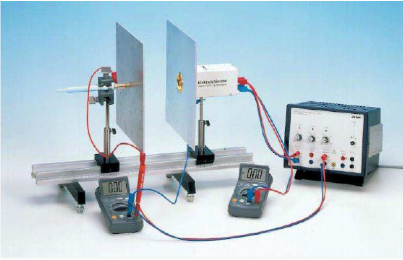
Şekil 4.1 Voltajın ve düzlemler arası mesafenin bir fonksiyonu olarak elektrik alan şiddetinin ölçülmesi için düzenek
