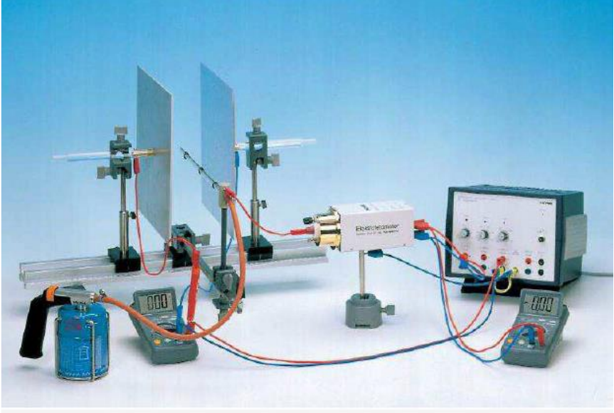
Şekil 4.2 Düzlem sığaçtaki potansiyeli, konumun bir fonksiyonu olarak ölçmek için düzenek.
