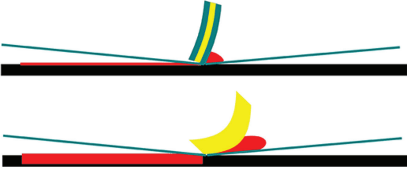
Şekil 6. Rakle Açısına bağlı mürekkep transferi ( https://pleiger.com )
