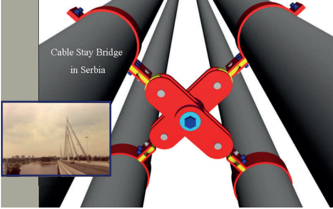
Şekil 3.13. Sırbistan’da köprü çelik kablolarında damper sistem uygulaması
