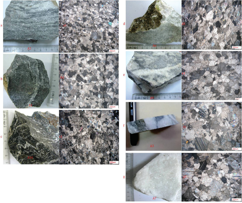
Şekil.5 Aphrodisias kristalin mermerlerin doğal örnekleri ve ince kesit mikrofotoğrafları.(ince kesitler N+ ve ölçek :250 µm). İnce kristalli açık grimsi siyah bantlı şisti mermer / A2 (a,a1), İnce kristalli grimsi –siyah kalsit damarlı mermer / A1 (b,b1), İnce kristalli siyah- kalsit damarlı mermer /A10 (c-c1), Orta kristalli açık gri mermer /A6 (d,d1), Orta kristalli beyaz gri mermer / A9 (e,e1), Orta kristalli beyaz –grimsi damarlı mermer /A3 (f,f1), Orta kristalli beyaz mermer /A7(g,g1).
