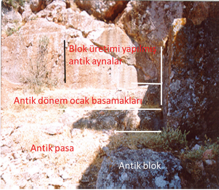
Şekil.5 Antik dönemlerde blok üretim basamak ve yüzeyleri.
