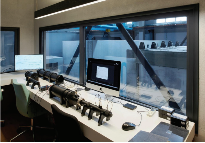
Görsel 1: Empedans Tüpü ve Ölçüm Laboratuvarı
