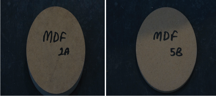
Görsel 2: 18 mm MDF (2A) ve 8 mm MDF (5B) Numune Örnekleri
